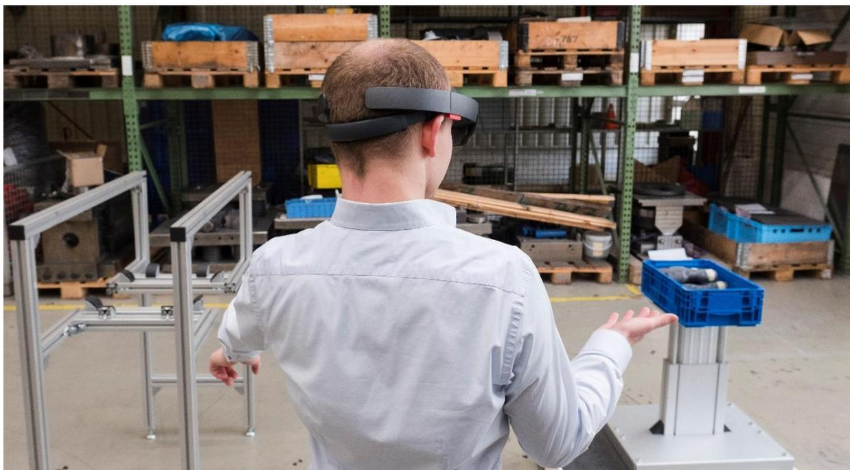
Bild 3: Ein Bediener steuert multimodal ein FTF
