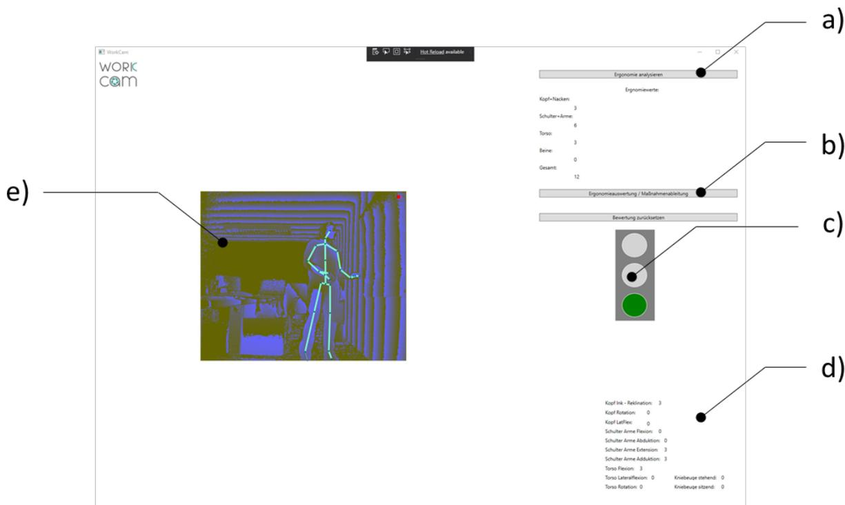
Abbildung 12: Bildschirmfoto der EBS-Software im Einsatz, a) Bedienelement zum Starten der Ergonomieanalyse, b) Bedienelement zur Auswertung und Maßnahmenableitung, c) Ampel-Indikator zur momentanen Ergonomiebewertung, d) Bewertungsaufschlüsselung
