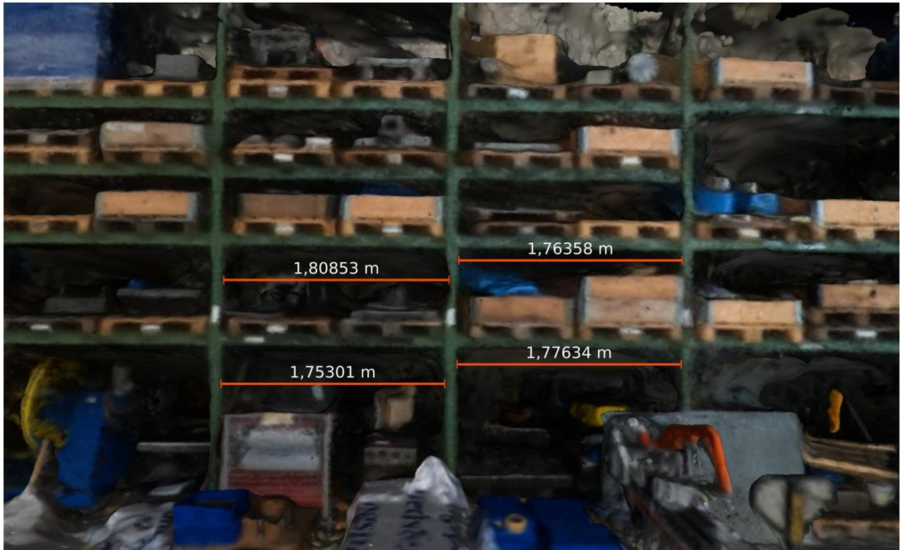
Bild 16: Auszug Referenzmessung für Validierung der Genauigkeit
