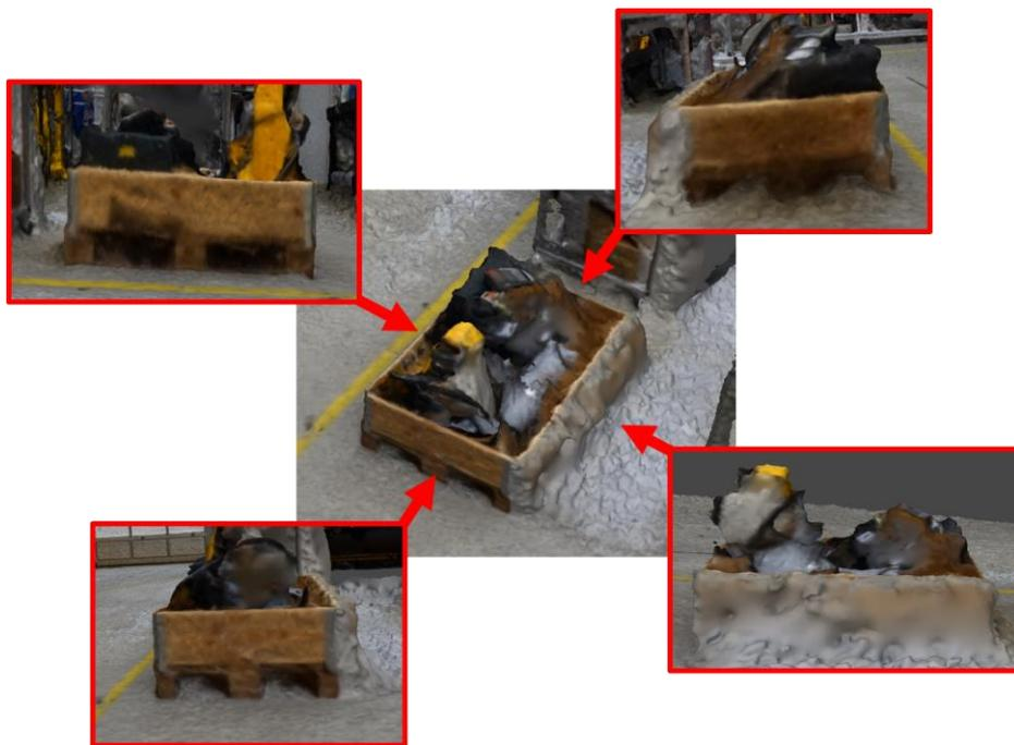
**Bild 10: Automatisierte Objekterkennung auf Basis von 2D-Perspektiven des 3D-Objekts**
