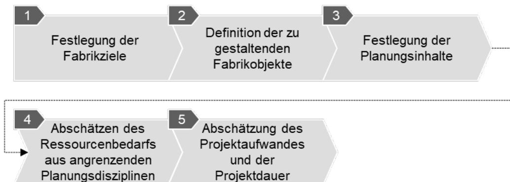
Abbildung 25: Schritte im Vorgehensmodell der Projektstrukturierung der Fabrikplanung (Bussemer 2019)
