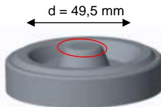
**Bild 3-3: Obergesenk der entwickelten Versuchsgeometrie für experimentelle Untersuchungen des losgrößenabhängigen Werkzeugverschleißes**
