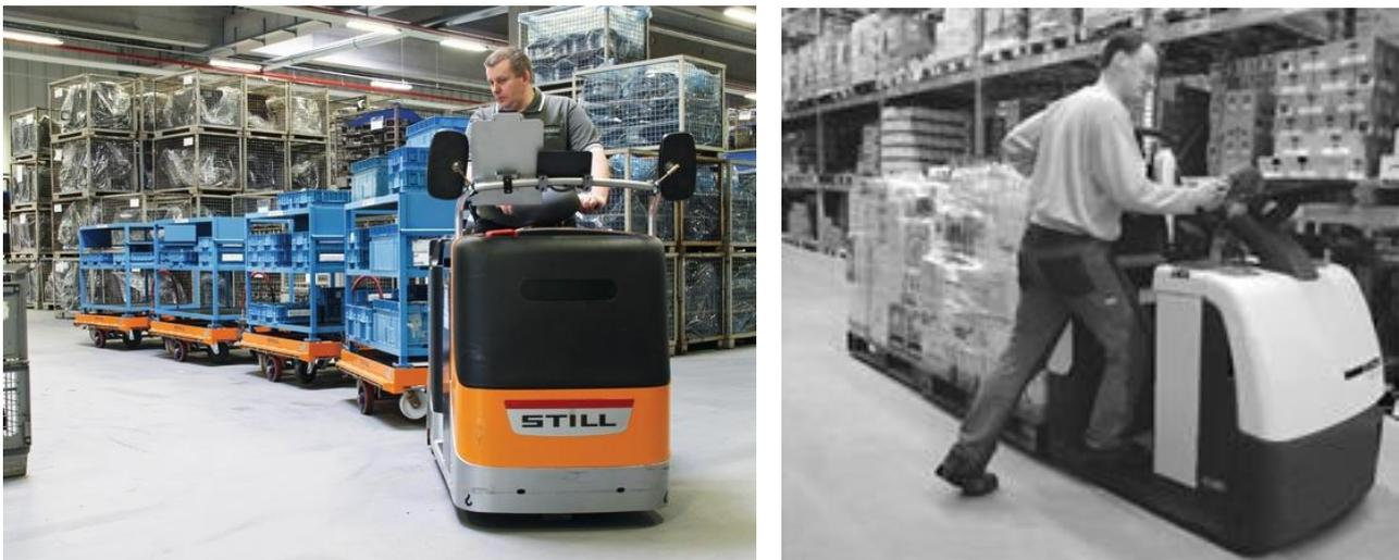
*Abbildung 9: Schleppzug (links) und Niederhubwagen mit Fahrerstand (rechts)
