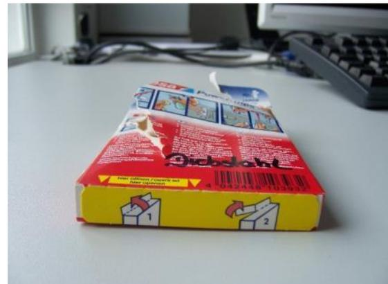
**Abbildung 33: Öffnungsspuren durch zerstörten Packstoff - a): bei einer Skinverpackung; b): bei einer Faltschachtel.**
