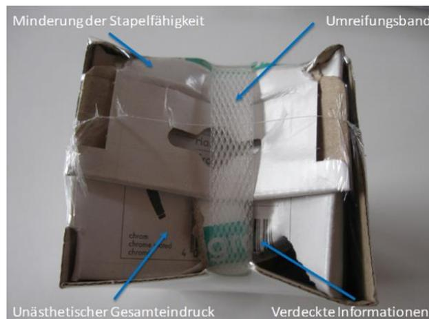
**Abbildung 48: Sicherung durch nachträglichen Einsatz von Packhilfsmitteln**
