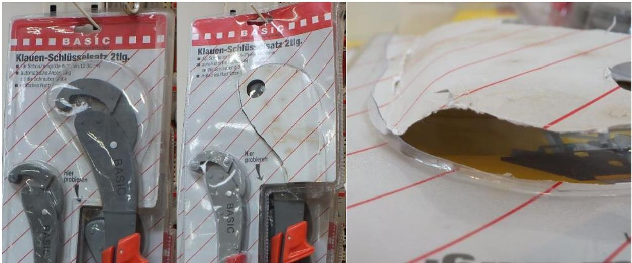
Abbildung 39: Vollverschweißte Blisterverpackung ist nur unter zur Hilfenahme von Werkzeugen zu öffnen - a) der Artikel in unversehrter Verpackung; b) der Artikel wurde aus der Verpackung entfernt; c) Schnittspuren vom Messer beim Auspackprozess
