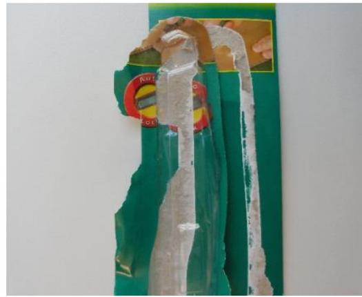
**Abbildung 32: Öffnungsspuren als Manipulationsindikatoren bei einer Blisterverpackung - a): Einsatz von Öffnungshilfen; b): Nachgeben der Siegelschicht auf der Substratoberfläche**
