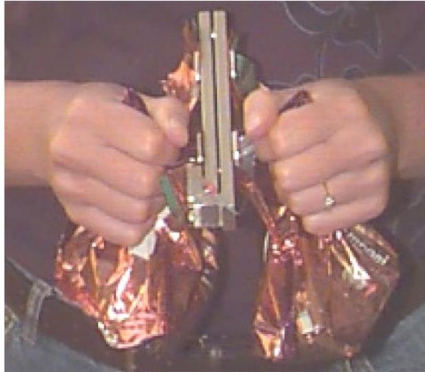
**Abbildung 44: Versuchsaufbau zur Bestimmung der maximalen Kraft bei einer auseinanderziehenden Bewegung**
