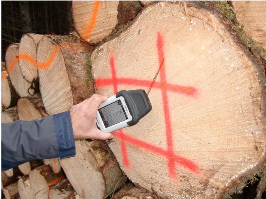
**Abbildung 27: Datenübertragung auf den Poltertransponder**
