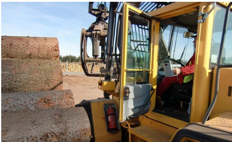
**Abbildung 30: Auslesen der Transponderetiketten auf dem Rundholzplatz**
