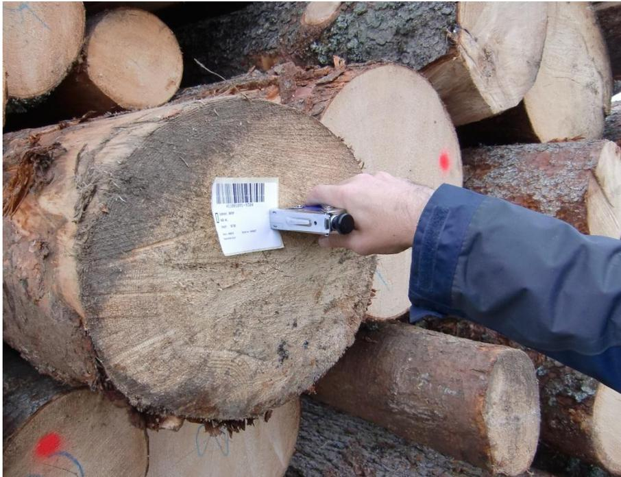
**Abbildung 29: Kennzeichnung der Fuhre auf dem Rundholzplatz mit einem Transponderetikett**
