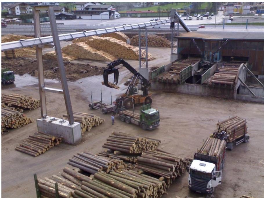
**Abbildung 2: Rundholzzwischenlager und Rundholzaufgabe im Sägewerk**
