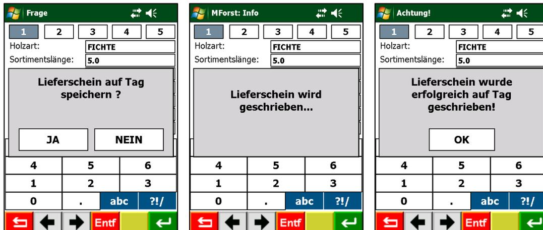
Abbildung 16: Datenübertragung auf den Transponder (Tag) (Screenshots aus *MobileForst@RFID*)
