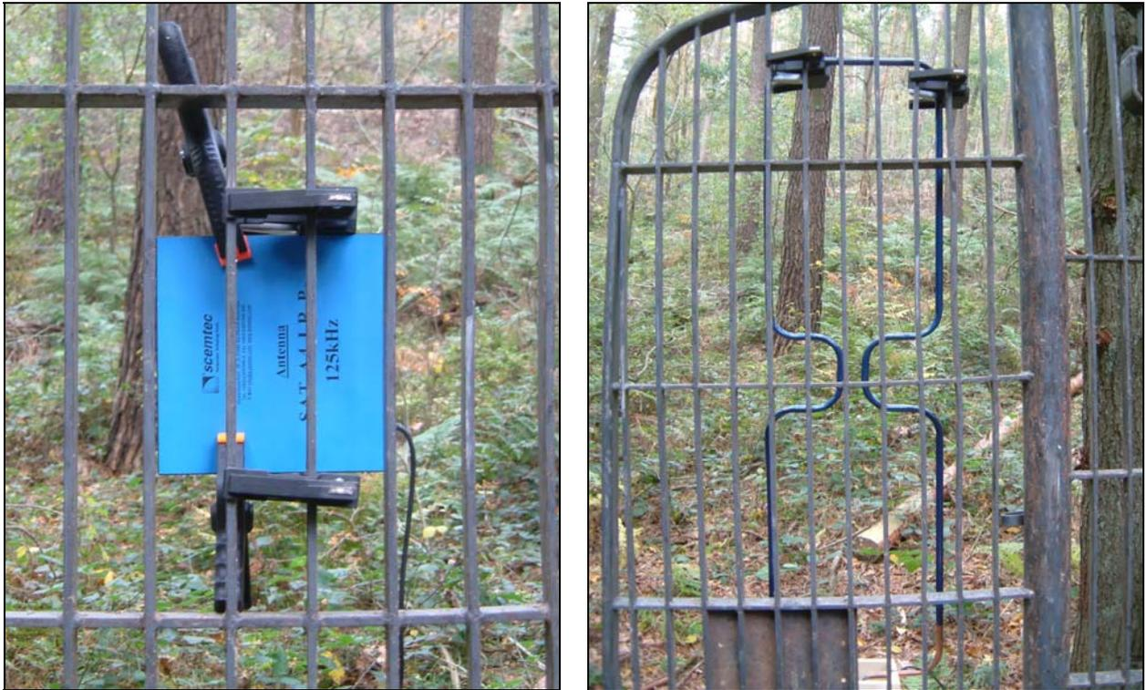
Abbildung 49: 125 kHz (links) und 13,56 MHz (rechts) Antenne an der Außenseite des Stirngatters
