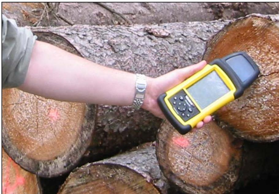
Abbildung 39: Manuelle Auslesung der Transponder am Polter mit MDE-Gerät
