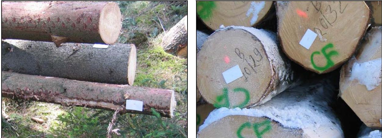
Abbildung 54: Seitlich (links) und stirnseitig (rechts) angebrachte HF-Transponderkarten
