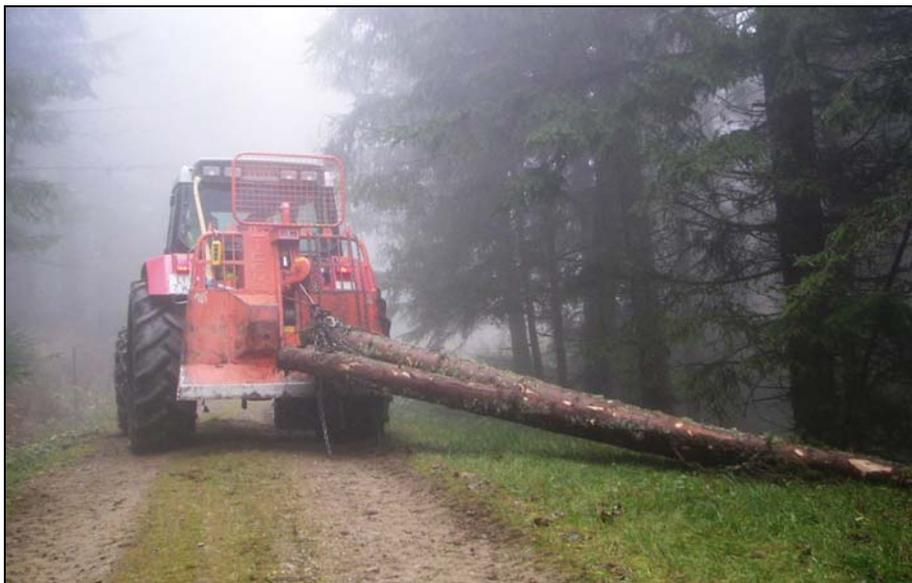
Abbildung 8: Seilschlepper bei der Rückung
