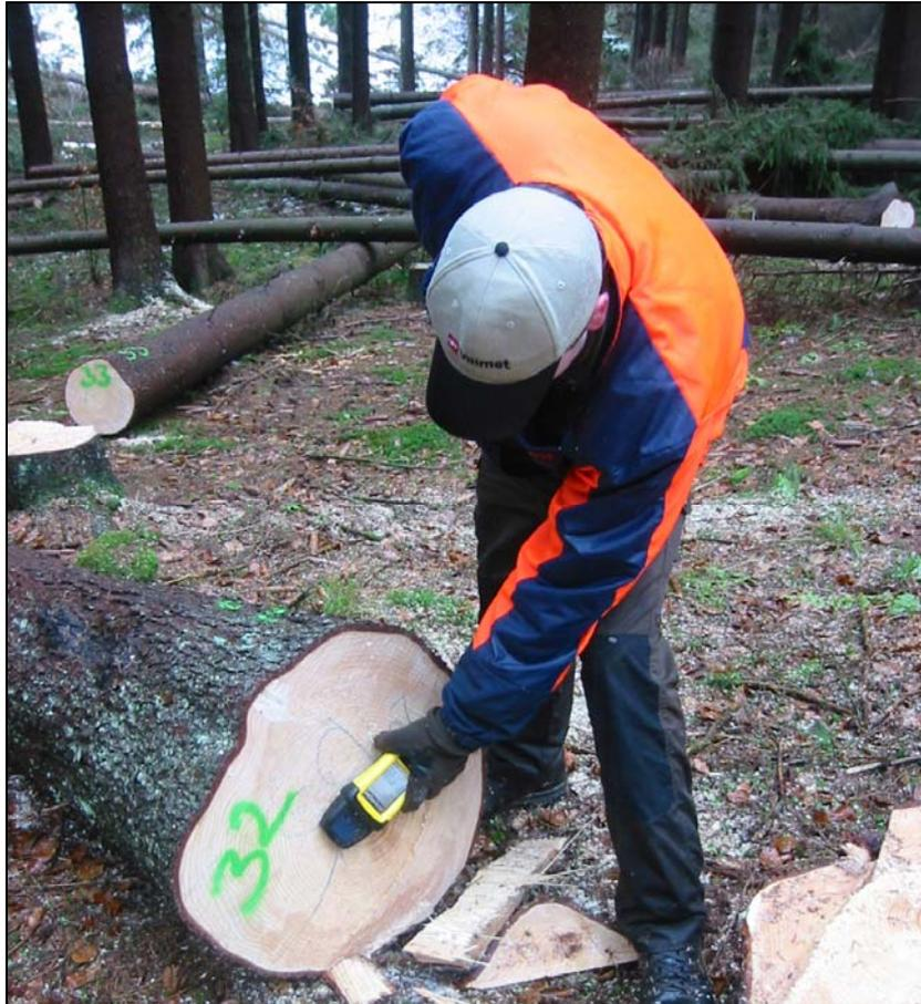
Abbildung 38: Manuelle Auslesung der Transponder im Zuge der Holzaufnahme
