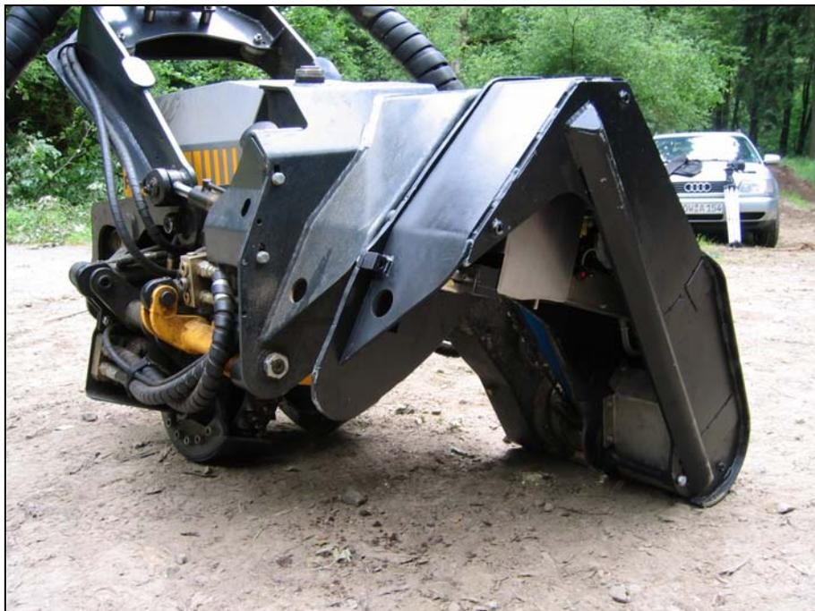
Abbildung 46: Applikationsvorrichtung am Harvesteraggregat
