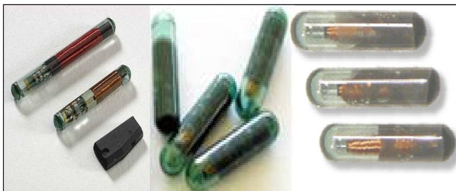
Abbildung 2: Transponder in Glaskapsel- und Schlüsselanhängerform
