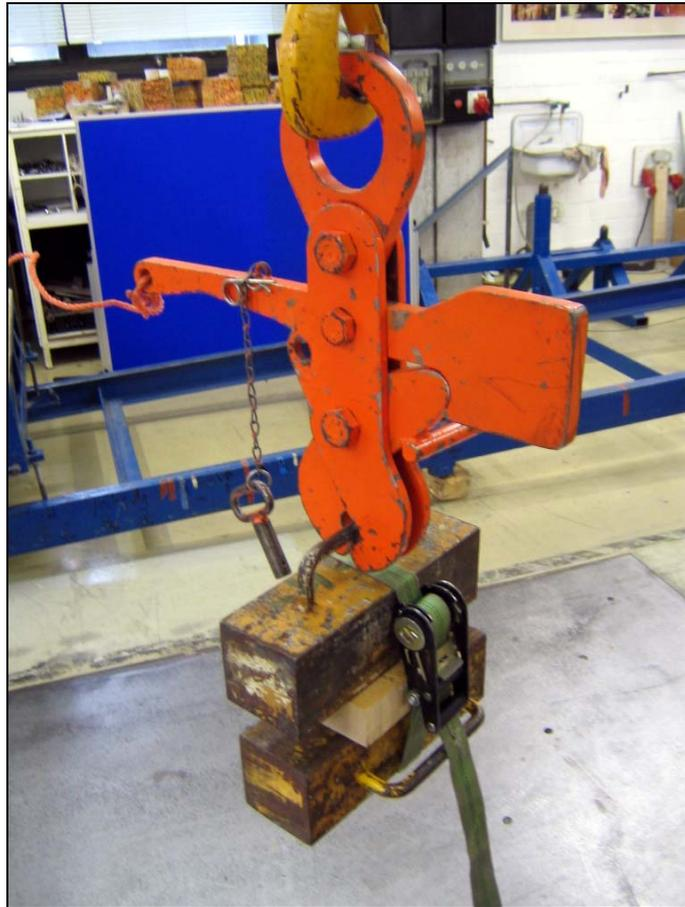
Abbildung 34: Versuchsaufbau für den Belastungsversuch Plasto-Label im LogIDLab®
