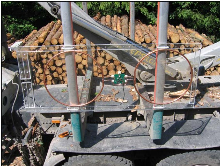
Abbildung 52: Kurzholz-LKW mit seitlich an den Rungen befestigter HF-Ausleseantenne
