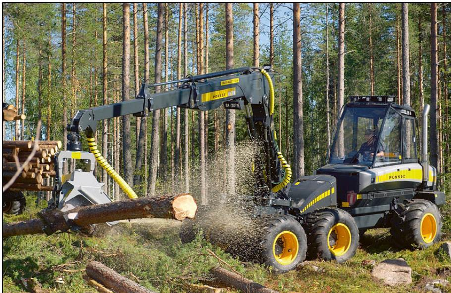
Abbildung 10: Harvester bei der Aufarbeitung
