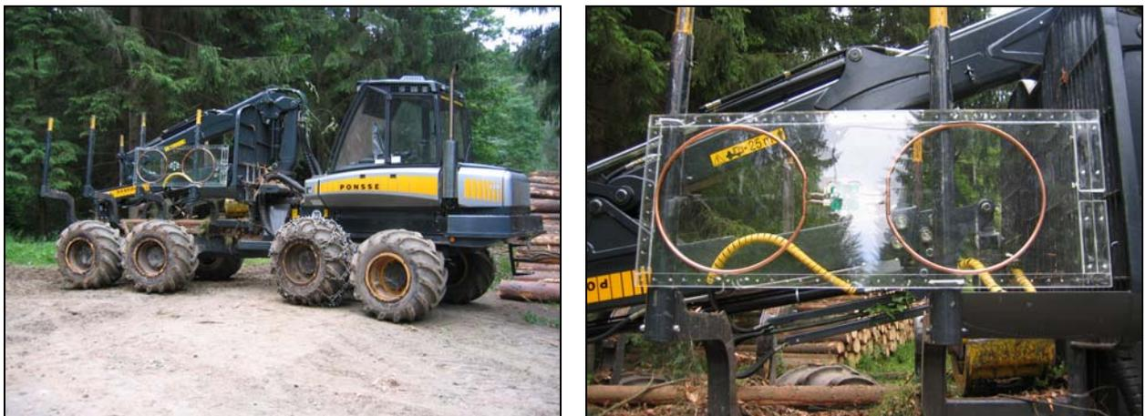
Abbildung 51: Forwarder mit seitlich außen an den Rungen befestigter HF-Ausleseantenne
