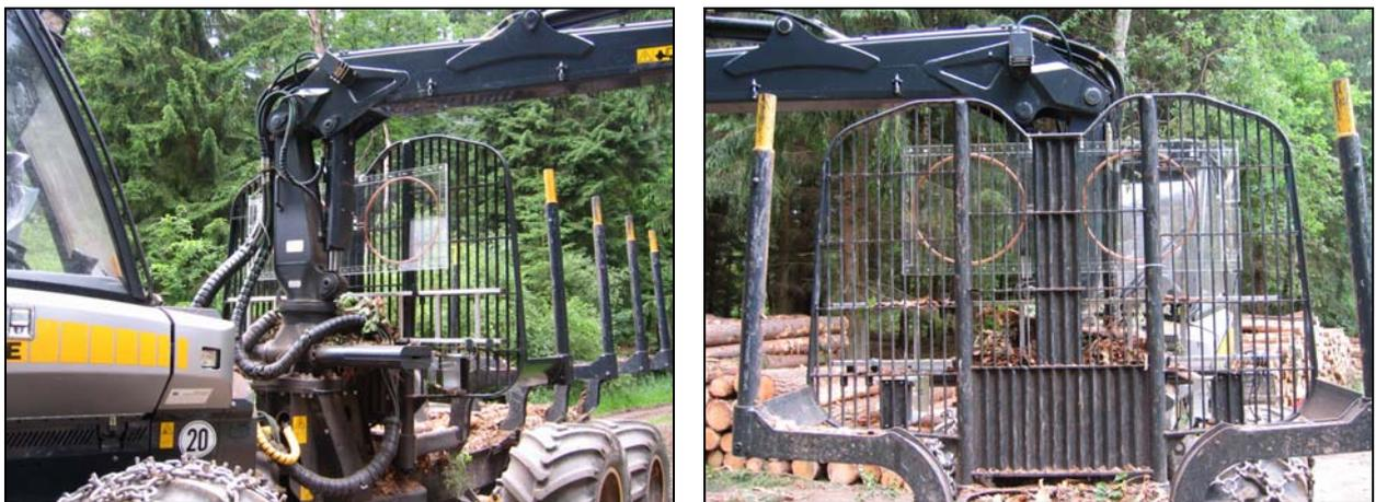
Abbildung 50: Forwarder mit außen am Stirngatter befestigter HF-Ausleseantenne
