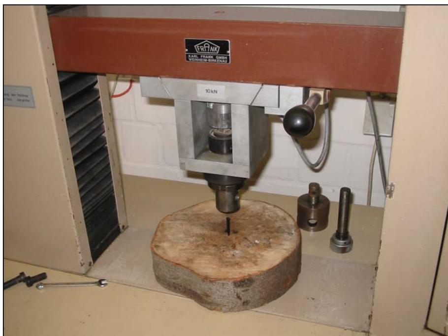
Abbildung 17: Versuchsaufbau Eindrücktests Nageltransponder im LogIDLab®
