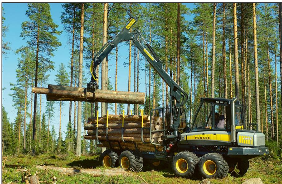
Abbildung 11: Forwarder beim Aufladen des Holzes
