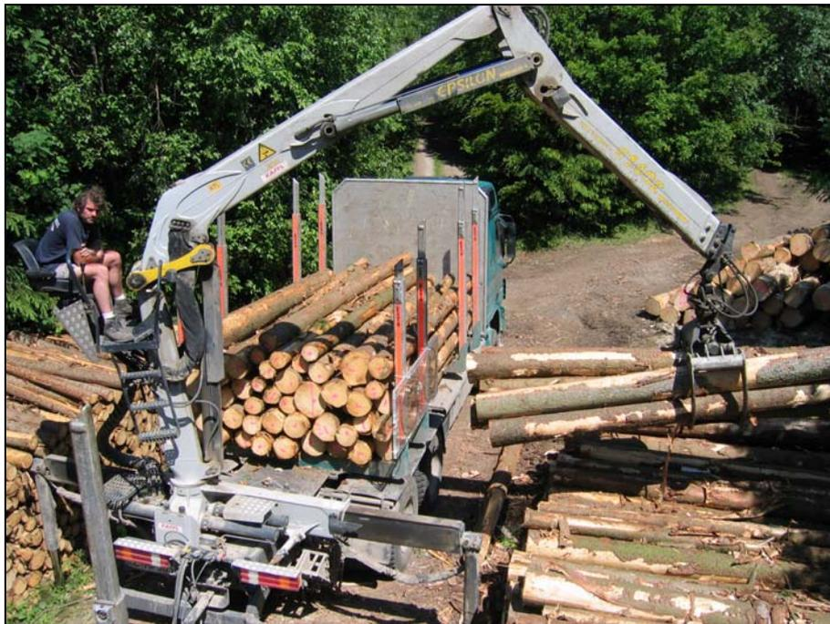
Abbildung 53: Auslesevorgang bei der Beladung des Rundholz-LKWs
