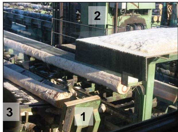
Abbildung 57: Ausleseantenne am Stammschieber (1) nach der Entrindung (2) und vor der Kappsäge (3)
