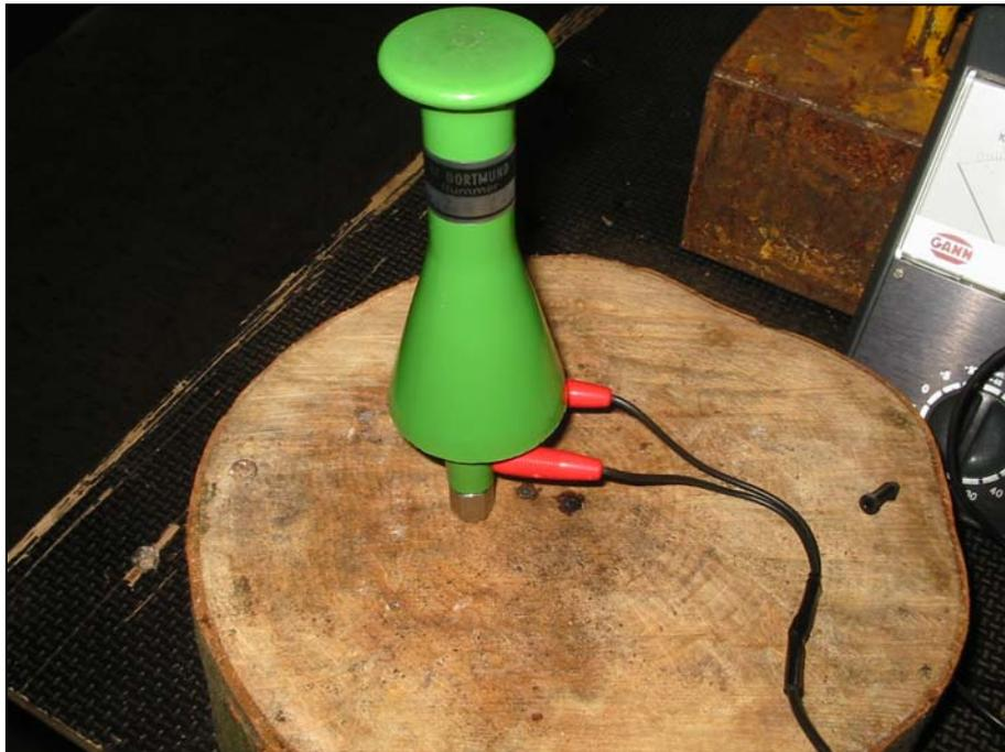
Abbildung 18: Messung der Holzfeuchtigkeit im LogIDLab<sup>®</sup>
