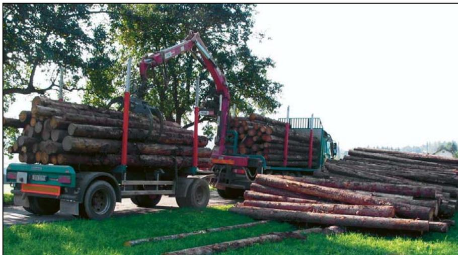
Abbildung 12: Kurzholz-LKW bei der Beladung
