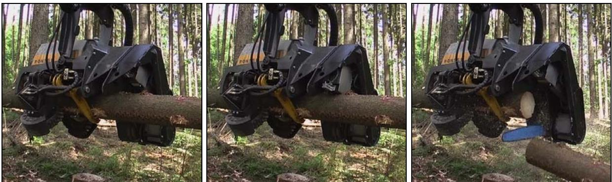
Abbildung 47: Arbeitssequenz der Applikationsvorrichtung
